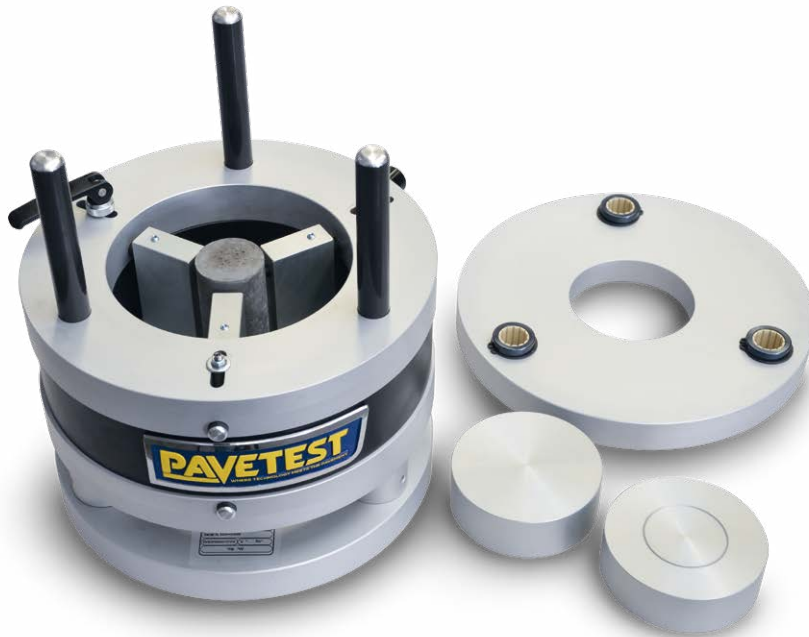
B202 Alet Noktası Sabitleme Jigi + küçük numune hazırlama aksesuarları
