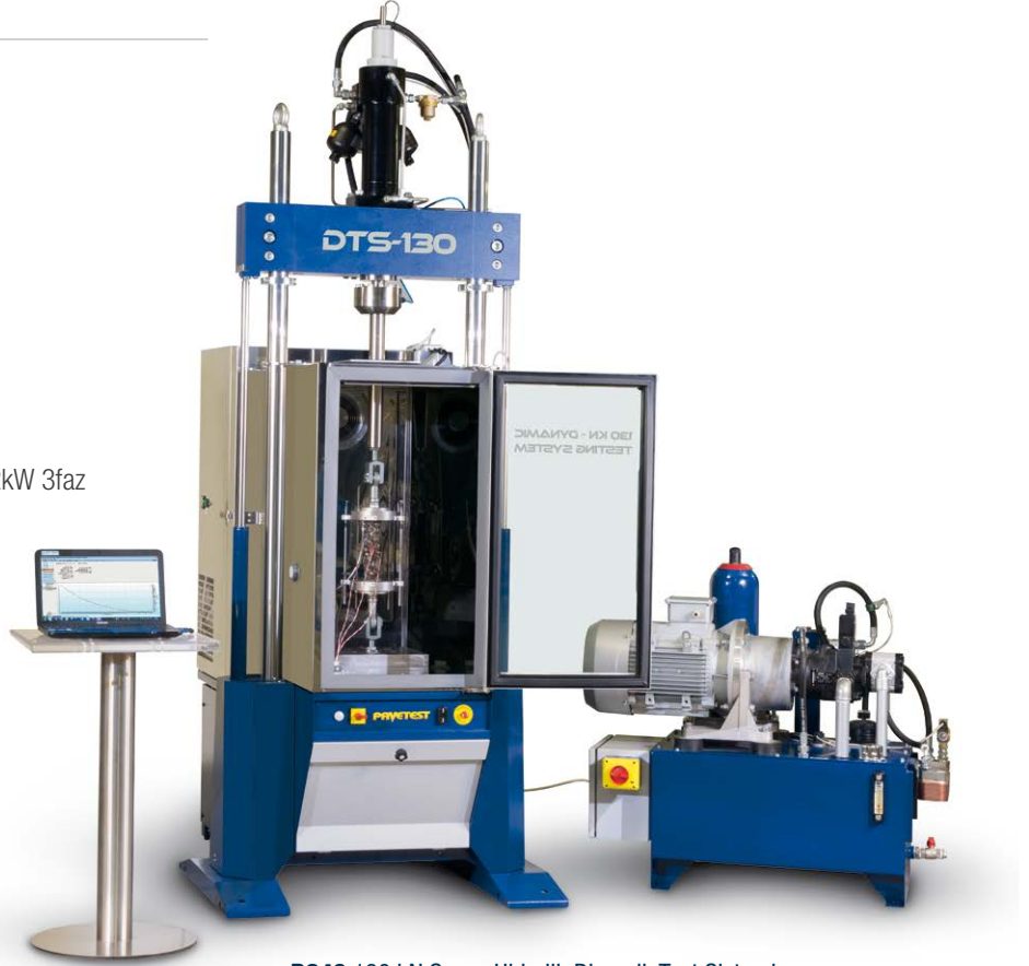
B240 130 kN Servo-Hidrolik Dinamik Test Sistemi H009-01EN PC, B231 Sıcaklık kontrollü kabin ve B240-03 Yağ/su değiştirici, HGK (hidrolik güç kaynağı)
